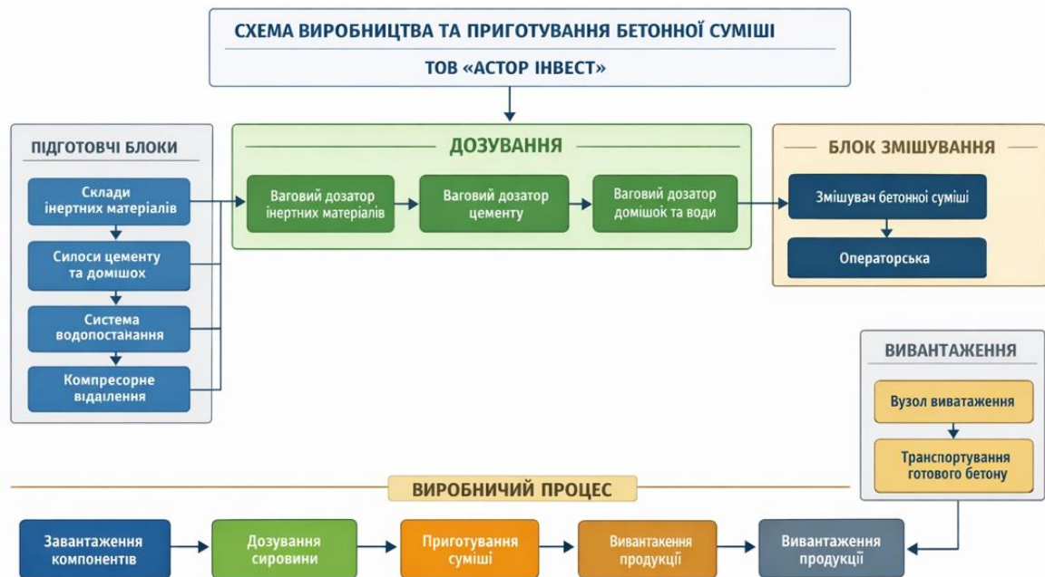
Рис. 1.5 – Принципова схема виробництва бетонної суміші
