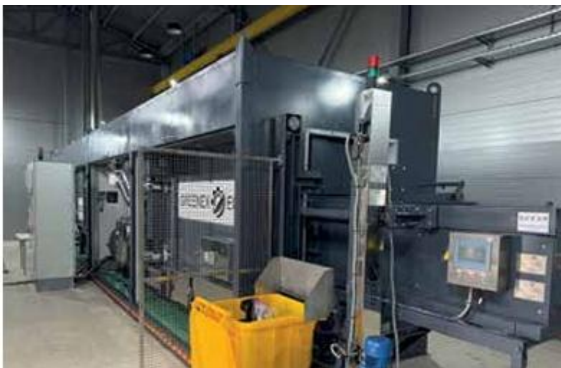
Рисунок 3.2.4.1 Установка для спалювання медичних відходів ECO-300M
