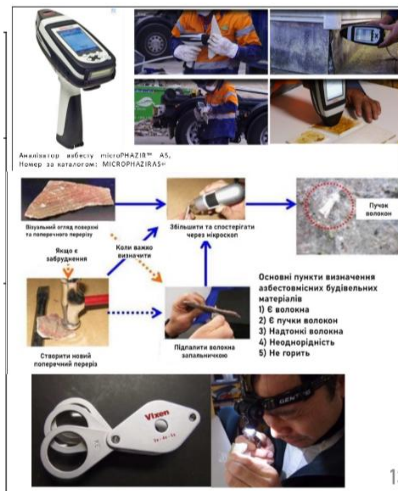
Рисунок 3.2.5.2. Система контролю наявності відходів, що містять азбест
