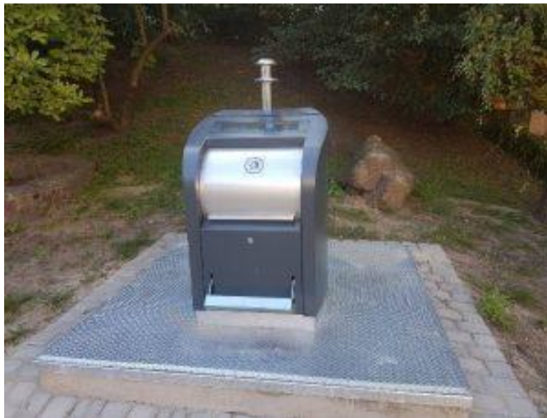
Рисунок 2.2.1.4. Підземні контейнери для збирання змішаних побутових відходів
