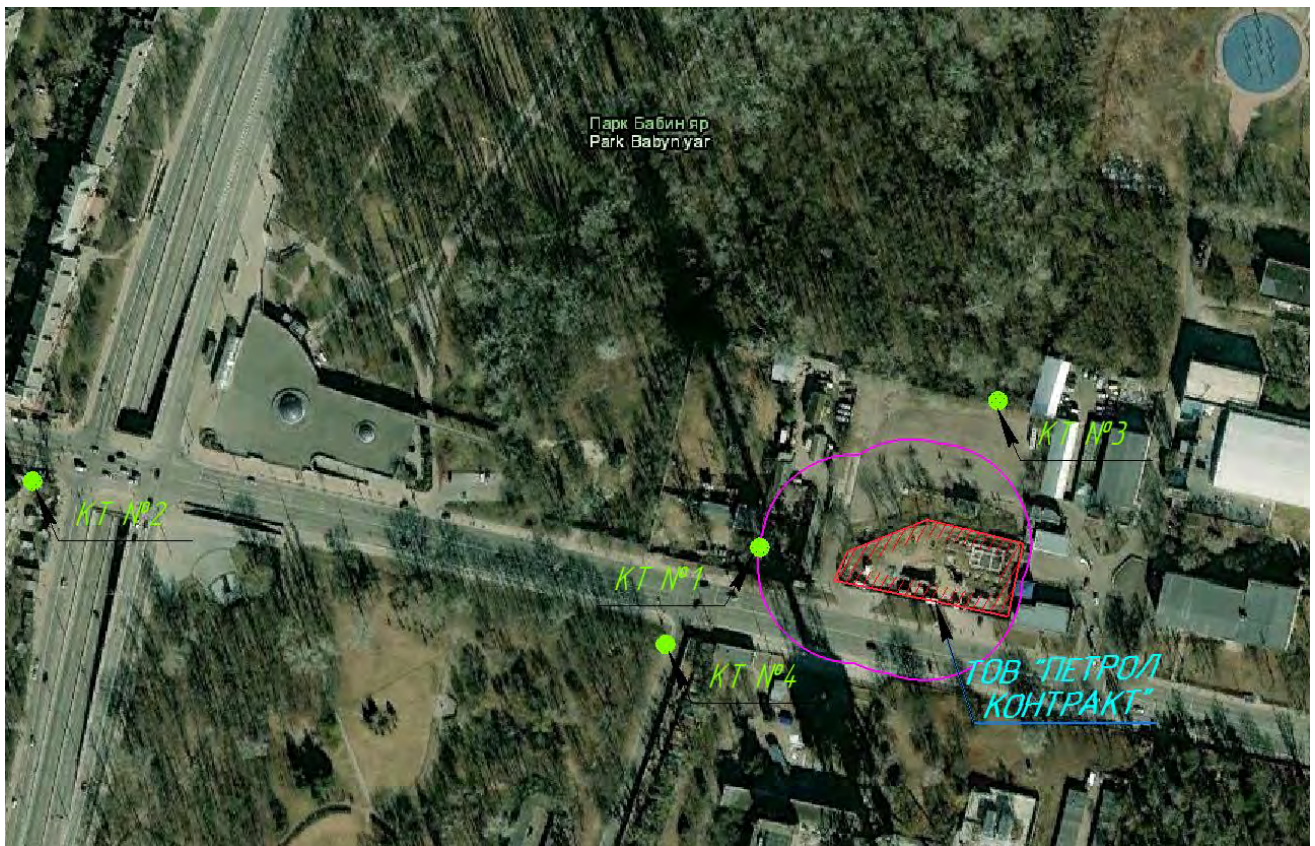
Мал. 8 Карта-схема розташування контрольних точок для розрахунку рівнів шуму
