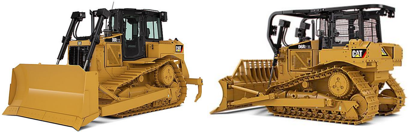
Рис. 17.1 - Зображення гусеничного бульдозеру CATERPILLAR модель D6R2
