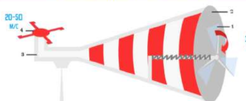
Рис. 3. Схема технології: 1 - пропелер з трьома лопатями, розміщений на горизонтальній осі з механічною пружиною; 2 - конус; 3 - труба; 4 - сегнерове колесо.
