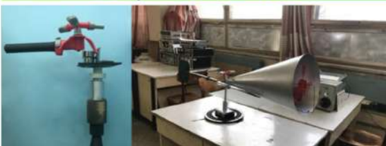
Рис. 1. Макет вітряного генератора використаний в експериментах
