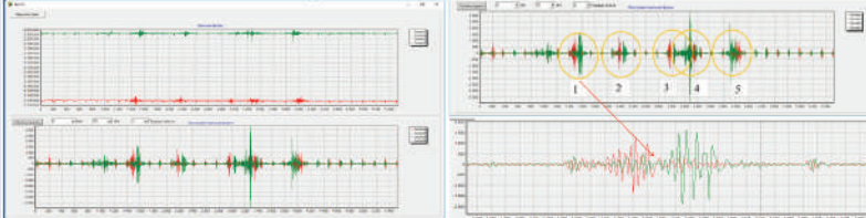
Рисунок 7. Значні халявкові форми з 2-х геофонів. Зелений колір – геофон №1, чорний колір – геофон №2. На малюку (вертикаль) можна побачити халявкові форми від лис геофонів. Зелений колір – геофон №1, чорний колір – геофон №2. В аналізований час проведена фільтрація даних з частот від 5 до 15 Гц.
